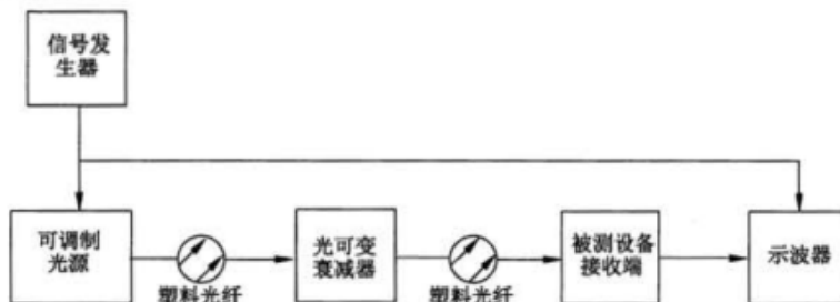
图 9 光接收脉冲宽度失真测试系统示意图
